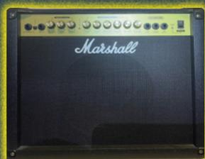
Zwei Kanäle clean und overdrive (dirty), mp3/CD-Eingang, Emulated Line out, Kopfhörerausgang, 3-Band EQ, Reverb, Contour Regler, 30 Watt, Fußschalter zum Umschalten zwischen clean und dirty
